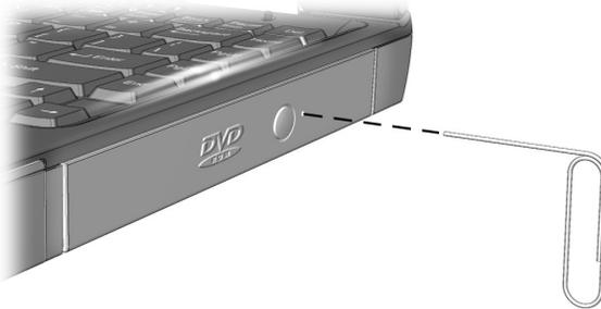
2. Introduisez une petite épingle, un trombone par exemple (d'environ 1/16 de pouce de diamètre et d'au moins 3/8 de pouce de long) dans le **Manual Eject Hole** (Fente prévue pour le retrait manuel) puis poussez fermement comme sur l'image ci-dessus.
