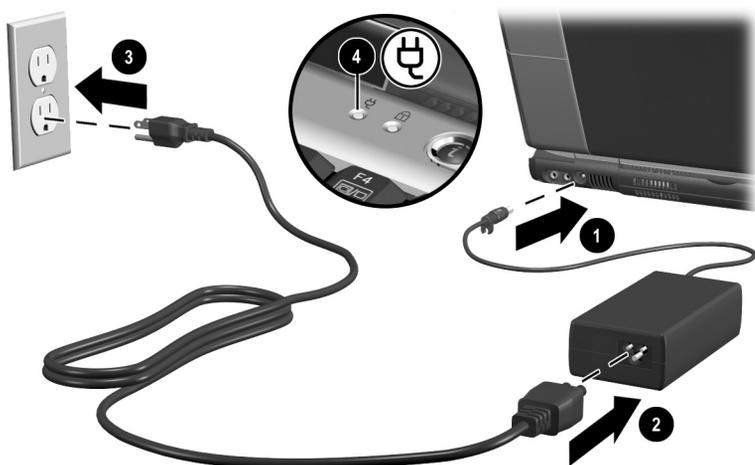
**将笔记本电脑与外部电源连接**（交流适配器、电源线和电源插座因使用地区而异）
