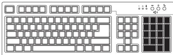
Lorsque la diode électroluminescente Verr Num du clavier est allumée, les touches numériques fonctionnent comme celles d'une calculatrice de base. Lorsque la diode électroluminescente Verr Num du clavier est éteinte, les touches numériques correspondent aux touches directionnelles utilisées dans les jeux ou pour déplacer le curseur. Appuyez sur la touche Verr Num chaque fois que vous désirez verrouiller ou déverrouiller les fonctions des touches numériques.
