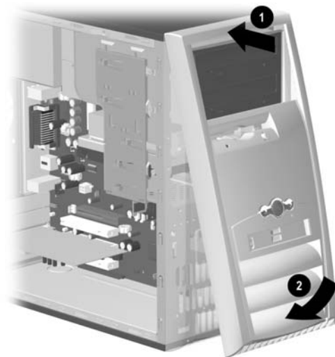
Voorpaneel van het 6000-model terugplaatsen
