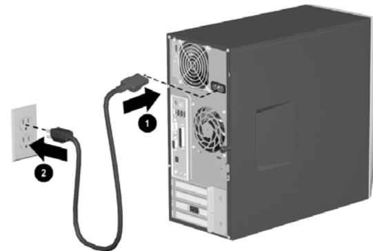
Netsnoer opnieuw aansluiten op het 6000/8000-model (6000 is afgebeeld)
