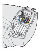
6 Halten Sie den Druckkopf an seinem Griff und setzen Sie ihn in den Sockel ein, dessen Etikettfarbe der Etikettfarbe des Druckkopfes entspricht. Der Tintenaufnahmestift muß zur Vorderseite des Druckers hin gerichtet sein.
