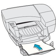
4 Legen Sie einen Stapel Papier, Transparentfolien oder Umschläge mit der zu bedruckenden Seite nach unten ein; achten Sie darauf, daß die rechte Seite des Stapels an der rechten Seite der Kassette anliegt. Das Zusatzpapierfach hat eine Kapazität von bis zu 250 Blatt Papier (ein bis zu 26 mm hoher Stapel).
