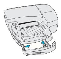
6 Schließen Sie die Zufuhrkassette. Wenn die Kassette ganz aus dem Zusatzpapierfach herausgezogen wurde, setzen Sie die Kassette auf einer Ebene ab, die genau so hoch ist wie das Papierfach, setzen Sie die Kassette in das Fach ein und schieben sie dann ganz hinein.
