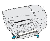
So laden Sie Druckmedien in das Zusatzpapierfach für den HP 2000C Professional Series
