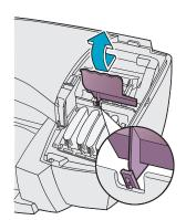
8 Setzen Sie die Druckkopfabdeckung wieder ein. Setzen Sie die hintere Kante der Abdeckung zuerst ein, und klappen Sie die Abdeckung herunter, so daß sie einrastet. Schließen Sie die Tintenpatronenabdeckung.
