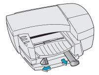
3 Legen Sie einen bis zu 16 mm hohen Stapel Papier, Transparentfolien oder Umschläge mit der zu bedruckenden Seite nach unten in das Zufuhrfach ein, und schieben Sie den Stapel bis zum Anschlag in den Drucker hinein.
