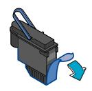
5 Nehmen Sie den neuen Druckkopf HP No. 10 aus der Verpackung und halten Sie ihn an seinem farbigen Griff. Achten Sie darauf, den goldfarbenen Metallstreifen am Druckkopf nicht zu berühren und, ziehen Sie den durchsichtigen Schutzstreifen, der die elektrischen Kontakte und Tintenstrahldüsen abdeckt, vorsichtig ab.
