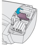
b) Heben Sie die Druckkopfverriegelung an und drücken Sie sie gleichzeitig nach hinten, so daß die Sockel für die Druckköpfe vollständig freigelegt werden. Die Druckkopfverriegelung sollte hinten auf dem Drucker zu liegen kommen.
