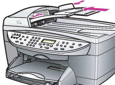
Deslice el extensor de la bandeja del alimentador automático de documentos en la parte superior del dispositivo. Haga coincidir las lengüetas grises con las ranuras negras.
