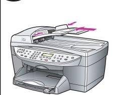
將自動文件送紙器 (ADF) 延伸槽滑入裝置 的頂端。將灰色的凸出 點對準黑色插槽。
