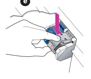
將卡閂的末端拉向您,往下按到 底,然後放開。確定卡閂卡住下 端的凸出點。對於藍色卡閂,請 重複相同步驟。
