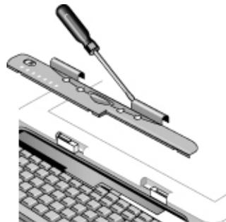
5. Desserrez les quatre vis cruciformes situées en haut du clavier (elles restent fixées au clavier).
