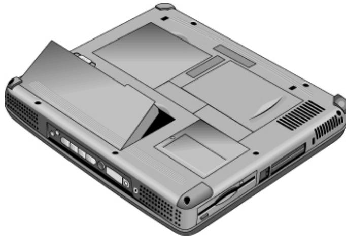
Lorsque vous avez installé la batterie, rechargez-la en branchant l'adaptateur secteur sur l'ordinateur pendant que vous travaillez. Vous pouvez également remplacer une batterie faible par une autre chargée.
