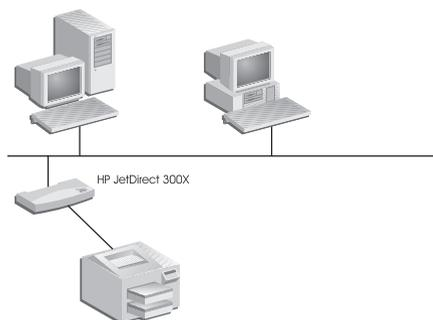
**Abbildung 1.1** Verwenden Sie einen externen HP JetDirect 300X, 170X oder EX Plus Druckserver, um ein Peripheriegerät an das Netzwerk anzuschließen.
