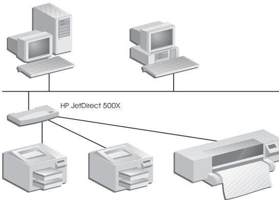
**Abbildung 1.2** Verwenden Sie den HP JetDirect 500X oder EX Plus3 Druckserver, um bis zu drei Peripheriegeräte an das Netzwerk anzuschließen.
