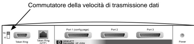
**Figure 3-1** Server di stampa HP J3264 con il commutatore della velocità di trasmissione dati Token Ring impostato su 16 Mbps
