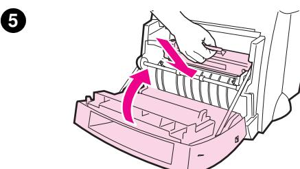
Sıkışan kağıt çıkarılırken yırtılabilir. Yazıcıda kalmış olabilecek küçük kağıt parçalarını çıkarmak için aşağıdaki işlemleri yapın.
