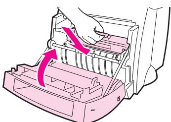
กระดาษติดขัดอาจเกิดการฉีกขาดได้ระหว่างการนำออก ให้ทำการขันตอนต่อไปนี้ในการนำกระดาษชิ้นเล็กๆ ที่ตกค้างอยู่ออกจากเครื่องพิมพ์
