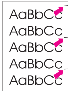
Defectos repetidos en sentido vertical
