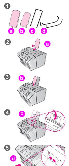
Es preciso instalar cuatro soportes de los medios o elementos que se introducen o que salen de la HP LaserJet 3150.
