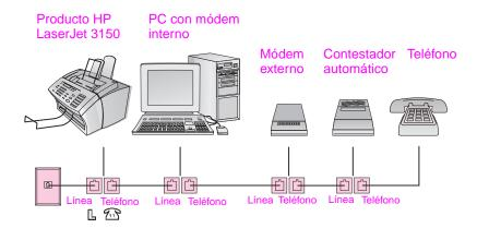
Si no desea conectar ninguno de los dispositivos enumerados, no tenga en cuenta esta sección. Conecte los dispositivos que tenga a la HP LaserJet 3150 en el orden indicado. *Véase "a. Preparación del producto y de otros dispositivos" en la página 30, para iniciar las instrucciones paso a paso.*
