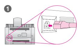
La HP LaserJet 3150 no tiene interruptor de encendido. Se enciende al conectar el cable de alimentación.
