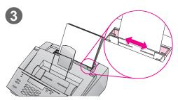
Puede cargar un máximo de 100 hojas de 75 g/m² en la bandeja de entrada de papel. La HP LaserJet 3150 imprime, copia e imprime los faxes recibidos mediante los soportes procedentes de la bandeja de entrada del papel (o de la ranura de entrada de hojas sueltas).
