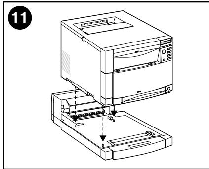
使打印机轻轻地落在双面打印附件上。当心: 在打印机下落时防止弄弯导栓。
