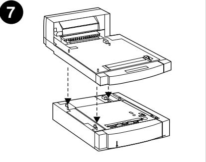
如果您安装500页送纸器，当双面打印附件下落时注意不要弄弯送纸器上的导栓。
