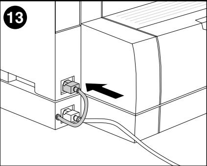
将双面打印附件上的电源线插入打印机背后的插座。
