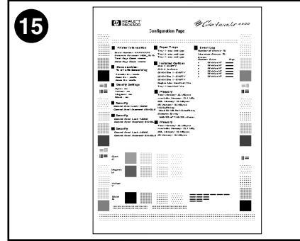
打印打印机配置页面, 核实 "Installed Options (已安装选项)" 下面显示了 "Duplex Unit Installed: YES (已安装双面打印设备: 是)"。
