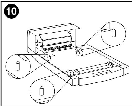
当打印机从双面打印附件上方下落时,请使用双面打印附件上的导栓校准打印机位置。
