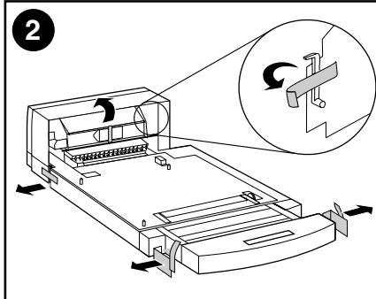
拆除附件背后的包装胶带，然后拆除前方抽斗上的包装胶带和隔离片。
