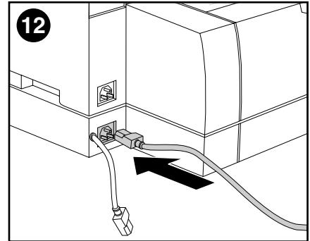
将打印机背后的电源线插入双面打印附件上的插座。
