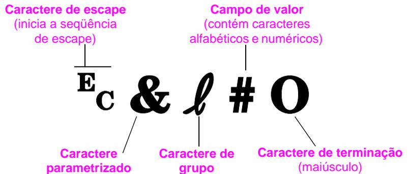
Figura D-1 Elementos de comando da impressora
