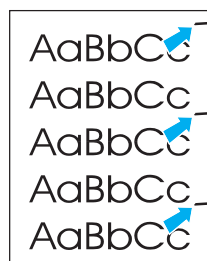
Defectos verticales repetidos
