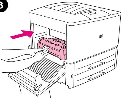
Använd båda händerna och skjut in enheten i skrivaren tills den snäpper på plats.
