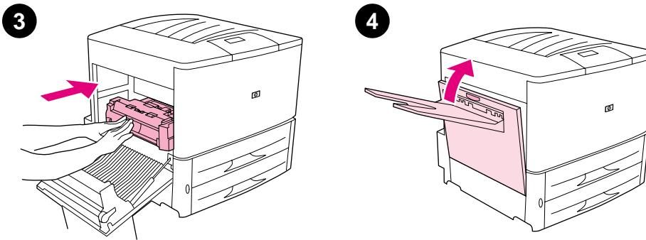
Mindkét kéz segítségével, csúsztassa a duplex egységet a nyomtatóba, amíg a helyére nem kattan.
