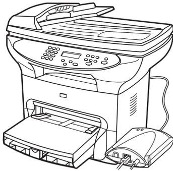
**HP LaserJet 3320n mfp** 為影印機中心型的產品，每分鐘最多列印和影印 15 頁 (ppm)，而且是平台影印機/掃描器的標準配備，它含有 50 頁的自動文件進紙器 (ADF)、32 MB RAM、可用來新增字型 and 記憶體的双排直插式記憶體模組 (DIMM) 插槽、USB 1.1 認證的連接埠，及 IEEE 1284-B 並列埠。
