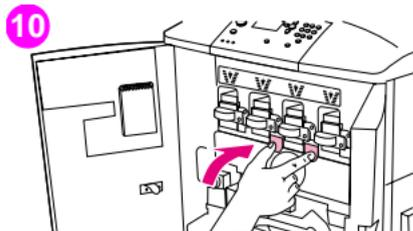
**10** Wiederholen Sie Schritt 5 bis 9 für alle auszuwechselnden Bildtrommeln. Schließen Sie die Klappe der Bildtrommel, indem Sie die Sperren am oberen Klappenrand drücken, bis sie einrasten.
