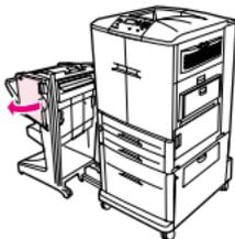
6 Entfernen Sie vorsichtig sämtliche Druckmedien aus dem Zufuhrbereich des Abschlussgeräts.
