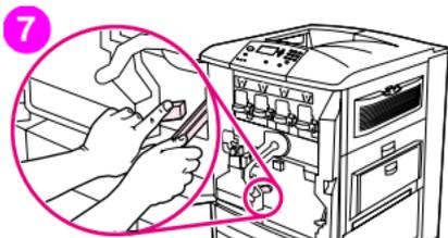
**7** Halten Sie sie nach unten gedrückt, und ziehen Sie die eingeklemmten Druckmedien mit der Papierzange heraus. (Sie finden diese in der Innentasche der rechten vorderen Klappe.) Achten Sie darauf, sämtliche Reste zerrissener Druckmedien zu entfernen.
