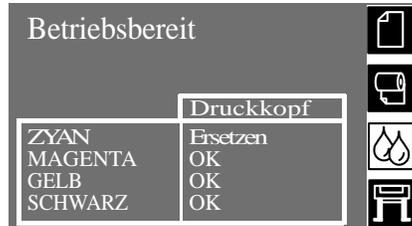
Beim Austauschen eines Druckkopfes muß der Drucker sowohl am rückseitigen Hauptnetzschalter als auch am **Netzschalter** im Bedienfeld ausgeschaltet sein.
