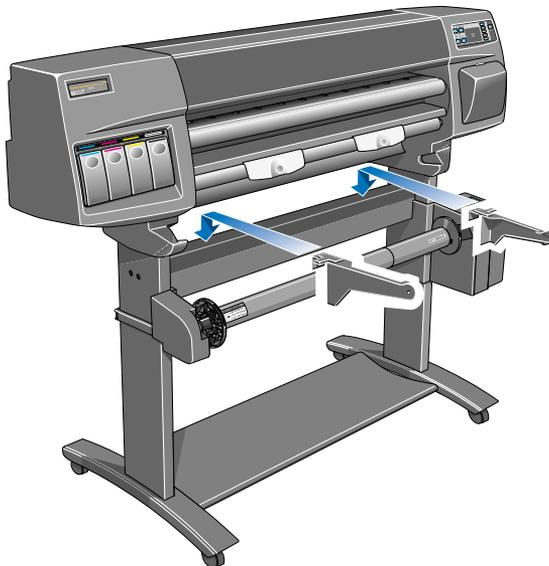
33. Schieben Sie die Halterungen der Medienumlenkung jeweils zur Seite, bis das T-Stück auf der Oberseite der Halterungen vollständig im Schlitz zwischen der Querverstrebung und der Gestelleinheit sitzt. Die Halterungen der Medienumlenkung sollten jetzt die Aufwickelvorrichtung berühren.
