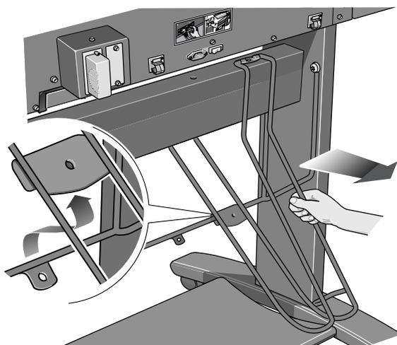
**9.** Usuń z nóżek zamocowanie pojemnika, odkręcając cztery wkręty. **W czynnościach opisanych poniżej nie używaj tych samych wkrętów, gdyż będą one zbyt krótkie.**
