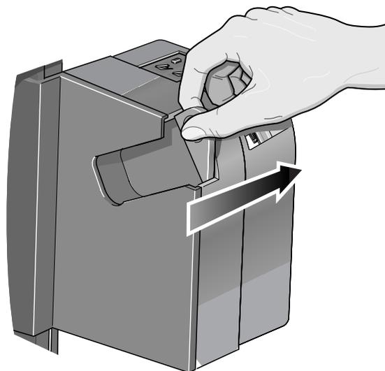
**30.** Zainstaluj trzpień jednostki nawijania papieru wciskając zdecydowanie końce A oraz B trzpienia.
