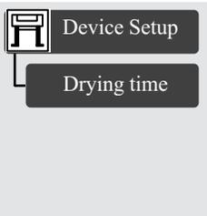
Możliwe są trzy ustawienia czasu schnięcia, opisane niżej. Zmiany ustawienia czasu schnięcia można dokonać wybierając z panelu przedniego drukarki menu Printer Setup [Konfiguracja drukarki], a następnie “Device setup [Konfiguracja urządzenia]” i “Drying time [Czas schnięcia]”. Bardziej szczegółowy opis znajduje się w drugim rozdziale *Instrukcji obsługi*.
