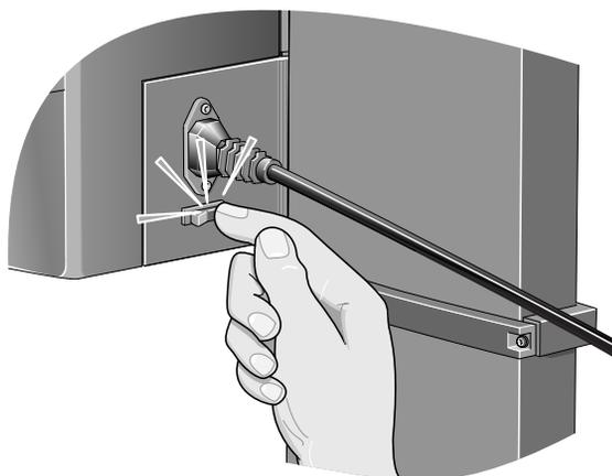
**37.** Jeżeli odłączony został kabel zasilania drukarki, należy go przyłączyć, włączyć zasilanie za pomocą przycisku bezpiecznika, a następnie włączyć drukarkę za pomocą włącznika na panelu przednim.
