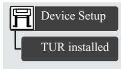
**1.** Na panelu przednim wybierz menu Printer Setup [Konfiguracja drukarki], a następnie opcje “Device Setup” [Konfiguracja urządzenia] i “TUR installed” [Zainstalowana jednostka nawijania papieru] i zmień wartość z **No [Nie]** na **Yes [Tak]**.
