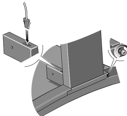
**26.** Przyłącz kabel zasilania do tyłu jednostki nawijania papieru.
