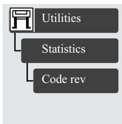
Numer wersji modułu programowego można sprawdzić wybierając na panelu przednim menu “Printer Setup”, a następnie opcje “Utilities”, “Statistics” i “Code rev”.
