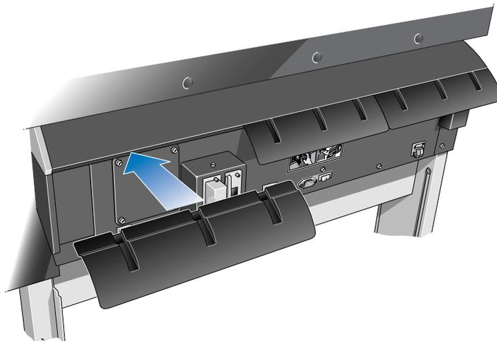
**14** Przyłącz kable zasilania oraz interfejsu, a następnie przełącz przycisk bezpiecznika.
