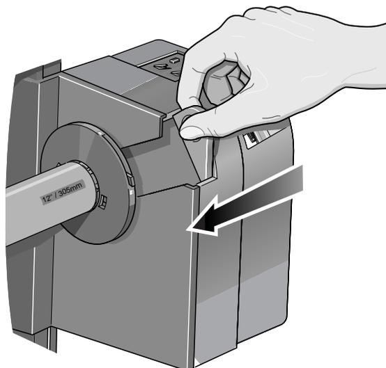
32. W zestawie jednostki nawijania papieru znajduje się prowadnica odchylająca, składająca się z dwóch uchwytych oraz drążka. Dopasuj lewy i prawy uchwyt do górnej części listwy mocowania.
