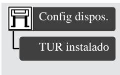
**1.** Usando o painel frontal, selecione o menu Configuração da Impressora, "Config. Dispositivo", "TUR instalado", e altere o valor de **Não** para **Sim**.
