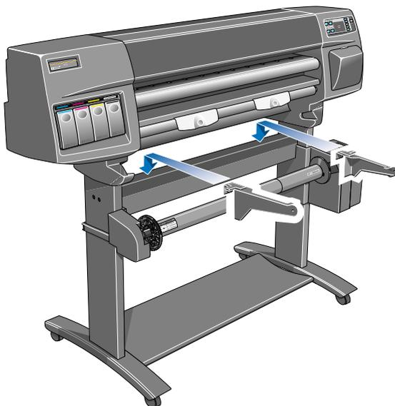
**33.** Deslize cada um dos suportes do defletor para o lado até que a peça em T na parte superior do suporte esteja totalmente inserida no espaço entre o apoio e o pedestal da impressora. O suporte do defletor deve estar tocando o conjunto do cilindro de recolhimento.
