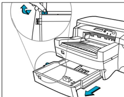
5. Legen Sie das Papier ein, indem Sie den Rand zuerst an der Papier-Längsführung anlegen. Klopfen Sie anschließend gegen die linke Seite des Papierstapels, damit der Stapel bündig an der rechten Seite des Faches anliegt.
