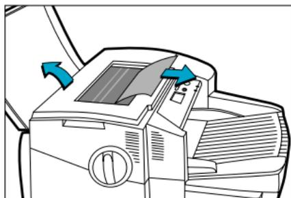
3. Falls es Ihnen nicht gelingt, das festsitzende Papier zu entfernen, können Sie den Hebel des Papierreglers herausziehen, den Regler selbst herausziehen und ihn anschließend drehen, um so das Papier zu entfernen.
