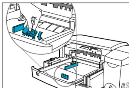
4. Wenn Sie Papierformate wie B4, A3, 279 x 432 mm oder 330 x 483 mm einlegen wollen, müssen Sie zuerst das Fach entriegeln, dann das Fach verlängern und anschließend das Fach wieder verriegeln.
