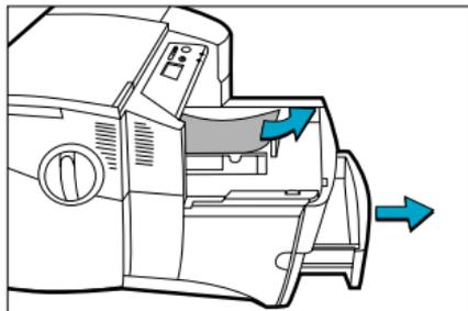
1. Entfernen Sie alle Druckmedien aus den Fächern 1, 2 und 3. Ziehen Sie sämtliches Papier, das offensichtlich im Drucker feststeht, heraus.
