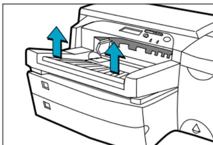
3. Lassen Sie die Papier-Längs-führung und -Querführung in die gewünschte Position einrasten. Die Papierformatmarkierungen befinden sich neben den jeweiligen Schlitzen.
