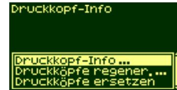
6. Wählen Sie mit den Tasten ↑ und ↓ die Option „Druckköpfe ersetzen,“ aus, und drücken Sie anschließend die Taste **EINGABE**.
