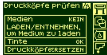
Im obigen Beispiel werden für einen oder mehrere Druckköpfe Meldungen für einen Austausch angezeigt. Um zu ermitteln, an welchem Druckkopf der Fehler vorliegt, wählen Sie das Druckkopfsymbol aus. Es wird der Status für alle Druckköpfe gleichzeitig angezeigt.
