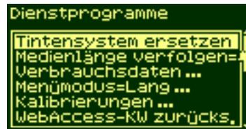
5. Wählen Sie **JA**, um das Tintensystem zu ersetzen.
