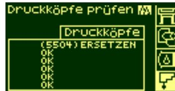
2. Wählen Sie mit den Tasten ↑ und ↓ die Option „Druckköpfe ersetzen“ aus, und drücken Sie dann die Taste **Eingabe**.
