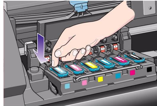
5. Setzen Sie **alle** Druckköpfe im Wagen ein, und schließen Sie die Abdeckung. Nur wenn **alle** Druckköpfe korrekt eingesetzt und vom Drucker erkannt wurden, ertönt ein Signalton.
