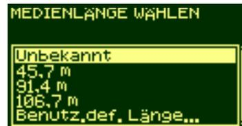
Wenn Sie die gleiche Rolle bereits schon einmal verwendet haben, ist es wahrscheinlich keine Rolle mit einer Standardlänge. Die Restlänge sollte am Ende der Rolle aufgedruckt sein (sofern Sie die Rolle nicht getrimmt haben). Wählen Sie in diesem Fall 'Benutz.def. Länge'.
