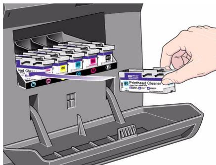
2. Depois que o limpador de cabeçote for inserido completamente, pressione para dentro e para baixo como indicado pela seta aqui, até que se fixe no lugar. O painel frontal não registra o novo limpador de cabeçote até que a porta direita tenha sido fechada.
