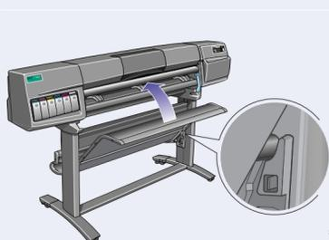
Kippen Sie die Ablage nach oben, bis die großen Stifte mit deren Vertiefungen und den vorhandenen Ablagen ausgerichtet sind.
