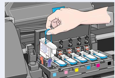
Ziehen Sie den Griff nach oben, bis sich der Setup-Druckkopf aus dem Druckkopfwagen löst. Vergewissern Sie sich, daß alle sechs Setup-Druckköpfe entfernt und entsorgt werden.
