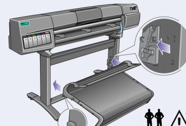
Setzen Sie die Ablage waagrecht in den Adaptern ein, und setzen Sie die kleinen Stifte in den entsprechenden Vertiefungen ein.
