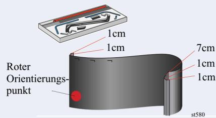
Nehmen Sie die Folie für die Papierablage aus dem Container. Falten Sie die Folie an fünf Stellen mit den oben angegebenen Abständen. Beachten Sie die Position des roten Orientierungspunktes im Verhältnis zu den Falten.
