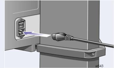
Schließen Sie das Netzkabel auf der Rückseite der Aufwickelvorrichtung an.
