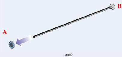
Entfernen Sie das blaue Endstück **A** vom linken Ende der Spindel, und stellen Sie die Spindel mit dem festen Endstück **B** senkrecht auf den Boden.
