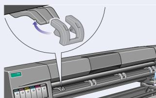
Installieren Sie die Verlängerungen an den Medienumlenkungen.
