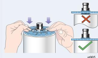
Setzen Sie das abnehmbare Endstück auf die Spindel auf, und drücken Sie es vollständig hinein.
