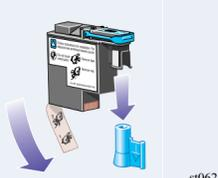
Ziehen Sie die blaue Schutzkappe und das transparente Klebeband von den Düsen des Druckkopfs ab.
