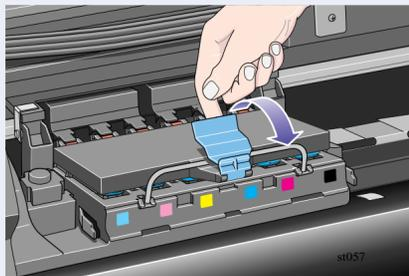
Ziehen Sie die Verriegelung auf der Oberseite des Druckkopfwagens nach oben, und lösen Sie diese.
