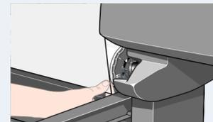
Halten Sie die Kanten des Mediums, die jetzt an der Ausgabeöffnung anliegen, fest. Richten Sie die rechte Kante des Mediums mit den Kanten der Rolle aus.
