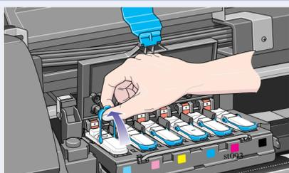
Um den **Setup**-Druckkopf zu entfernen, klappen Sie den blauen Griff nach oben.
