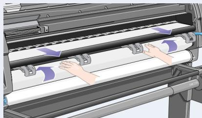
Führen Sie die Rolle soweit ein, bis sie gemäß obiger Abbildung vom Drucker eingezogen wird.
