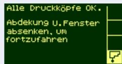
Wenn alle Druckköpfe korrekt installiert wurden, erscheint im Bedienfeld die obige Meldung. Schließen Sie die Abdeckung am Druckkopfwagen, und schließen Sie das Fenster.
