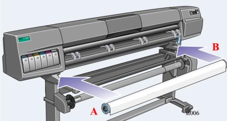
Schieben Sie die Spindel mit dem blauen Endstück gemäß den dargestellten Pfeilen **A** und **B** in den Drucker. Das Papier muß exakt wie in der Abbildung dargestellt herunterhängen.
