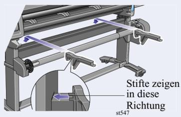
Installieren Sie die linke und rechte Medienumlenkung im oberen Bereich der Querverstrebung des Druckers.
