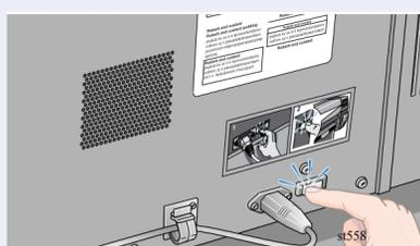
Bringen Sie den Netzschalter auf der Rückseite des Druckers in die Position **Ein**.
