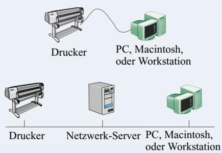
Ihr Drucker kann über ein paralleles Kabel direkt oder über eine Netzwerkverbindung an einem Computer angeschlossen werden.
