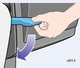
Wenn das Medium mit den Kanten der Rolle korrekt ausgerichtet ist, stellen Sie den Medienladehebel nach unten.
