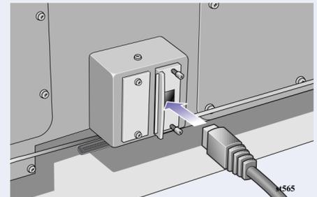
Wenn Sie eine Netzwerkverbindung verwenden, schließen Sie an der JetDirect-Karte auf der Rückseite des Druckers ein Netzwerk Kabel an.
