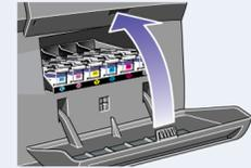
Nachdem Sie alle Druckkopfreiniger in der Servicestation eingesetzt haben, schließen Sie die Tür.
