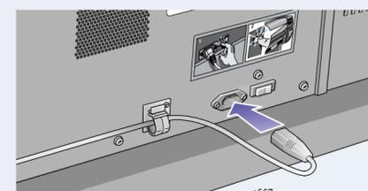
Schließen Sie das Netzkabel an der Netzanschlußbuchse neben dem Netzschalter und dann an der Steckdose an.
