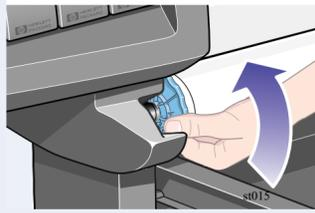
Wickeln Sie den losen Teil der Rolle vorsichtig auf die Spindel auf. Drehen Sie die Rolle am blauen, abnehmbaren Randhalter in die oben dargestellte Richtung.
