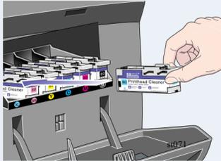
Setzen Sie die Druckkopfreiniger in den farblich korrekten Einschüben ein. Beachten Sie die Pfeilrichtung in der obigen Abbildung.
