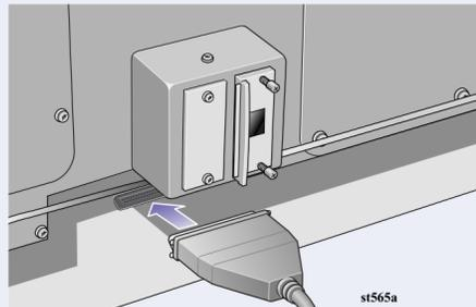
Wenn Sie den Drucker direkt am Computer anschließen, schließen Sie das parallele Kabel gemäß obiger Abbildung am Drucker an.
