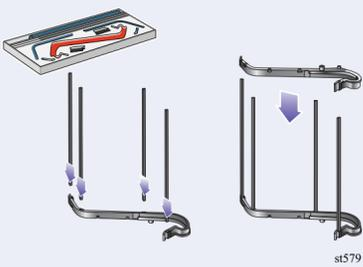
Setzen Sie die vier Stangen in den Vertiefungen an der rechten Halterung für die Medienablage ein, und befestigen Sie dann die linke Halterung an den vier Stangen.
