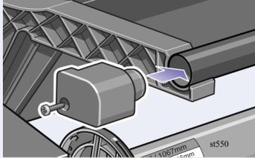
Bringen Sie die Endstücke an der Stange und an den Halterungen mit den beiden beiliegenden Schrauben an.
