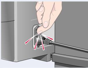
Schalten Sie die Aufwickelvorrichtung ein, indem Sie den Netzschalter auf der Rückseite auf **Ein** stellen.
