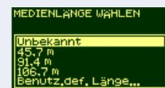
Im Bedienfeld erscheint die obige Meldung. Wählen Sie mit den Pfeil-nach-oben- und Pfeil-nach-unten-Tasten die Länge des geladenen Mediums aus. Die Länge ist auf der Verpackung des Mediums angegeben. Wenn Sie sich nicht sicher sind, wählen Sie die Option 'Unbekannt'.
