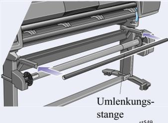
Die Umlenkungsstange befindet sich in der Aufwickelspule in Karton
