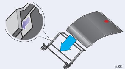
Schieben Sie die Folie für die Medienablage in die Nut an den Halterungen für die Medienablage. Setzen Sie das Ende mit den beiden Falten zuerst ein. Schieben Sie die Folie vollständig hinein, so daß sich die Falten an den korrekten Positionen befinden.
