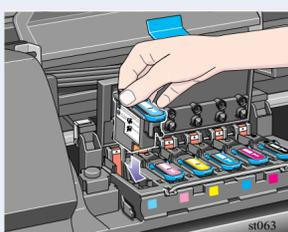
Drücken Sie den Druckkopf in die durch den Pfeil markierte Richtung nach unten. Wenn alle Druckköpfe korrekt eingesetzt sind und vom Drucker akzeptiert wurden, gibt der Drucker einen Signalton aus.
