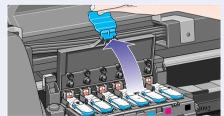
Klappen Sie die Abdeckung nach oben. Jetzt gelangen Sie an die Setup-Druckköpfe.
