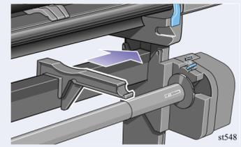
Schieben Sie die Halterung für die Medienumlenkung zur Seite, bis sich das T-Stück oben an der Halterung vollständig in der Lücke zwischen Querverstrebung und Standbein befindet.
