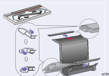
Befestigen Sie die Endstücke an der Folie und an den Seiten gemäß obiger Abbildung.
