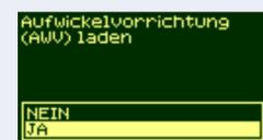
Wenn eine Aufwickelvorrichtung installiert ist, erscheint im Bedienfeld die obige Meldung. Wählen Sie mit den Pfeil-nach-oben- und Pfeil-nach-unten-Tasten die Option 'Nein'. Hinweise zum Laden der Aufwickelvorrichtung finden Sie in der *Kurzreferenz* oder im *Benutzerhandbuch*.
