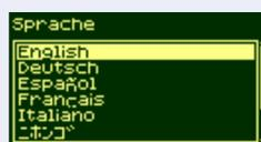
Wählen Sie mit den Pfeil-nach-oben- und Pfeil-nach-unten-Tasten die Sprache für die Bedienfeldanzeige aus. Drücken Sie die Taste **Eingabe**.
