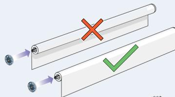
Schieben Sie die neue Rolle auf die Spindel. Vergewissern Sie sich, daß das Papier exakt in der dargestellten Ausrichtung geladen ist. Die blaue Medienführung muß sich links befinden.
