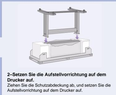
**2-Setzen Sie die Aufstellvorrichtung auf dem Drucker auf.**
