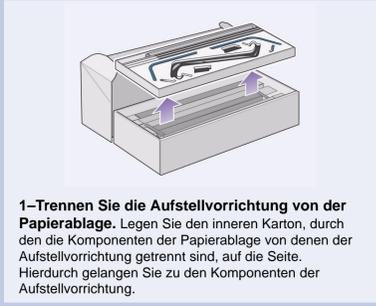
**1-Trennen Sie die Aufstellvorrichtung von der Papierablage.** Legen Sie den inneren Karton, durch den die Komponenten der Papierablage von denen der Aufstellvorrichtung getrennt sind, auf die Seite. Hierdurch gelangen Sie zu den Komponenten der Aufstellvorrichtung.
