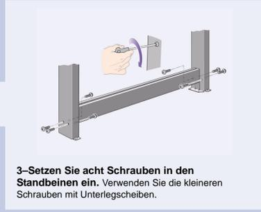
**3-Setzen Sie acht Schrauben in den Standbeinen ein.** Verwenden Sie die kleineren Schrauben mit Unterlegscheiben.
