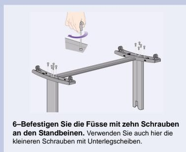
**6-Befestigen Sie die Füße mit zehn Schrauben an den Standbeinen.** Verwenden Sie auch hier die kleineren Schrauben mit Unterlegscheiben.
