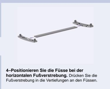
**4-Positionieren Sie die Füße bei der horizontalen Fußverstrebung.** Drücken Sie die Fußverstrebung in die Vertiefungen an den Füßen.
