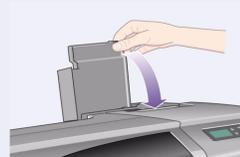
**3–Schließen Sie die Patronenabdeckung.** Nachdem die letzte Patrone eingesetzt wurde, beginnt der Drucker damit, sein Tintensystem zu initialisieren. Warten Sie ca. eine Minute, bis dieser Vorgang abgeschlossen ist.
