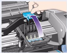
**3–Klappen Sie die Druckkopfabdeckung nach oben.** Hierdurch gelangen Sie an die Setup-Druckköpfe.
