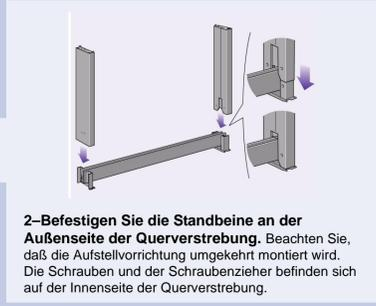
**2-Befestigen Sie die Standbeine an der Außenseite der Querverstrebung.** Beachten Sie, daß die Aufstellvorrichtung umgekehrt montiert wird. Die Schrauben und der Schraubenzieher befinden sich auf der Innenseite der Querverstrebung.
