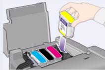
**2–Setzen Sie die Tintenpatronen in den korrekten Positionen ein.** Die Farben der Aufkleber auf den Tintenpatronen müssen mit den Farben der Aufkleber am Drucker übereinstimmen.
