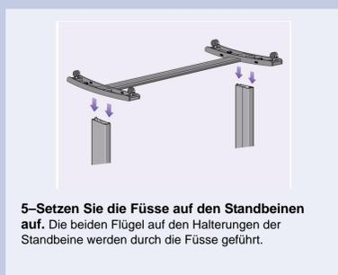
**5-Setzen Sie die Füße auf den Standbeinen auf.** Die beiden Flügel auf den Halterungen der Standbeine werden durch die Füße geführt.
