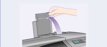
**1–Öffnen Sie die Patronenabdeckung** und nehmen Sie die Tintenpatronen aus ihrer Verpackung. Die Patronen befinden sich im "Installationspaket" mit der Dokumentation und anderen Teilen.
