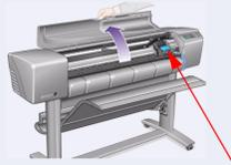
**1–Wenn Sie hierzu in der Bedienfeldanzeige aufgefordert werden, öffnen Sie das Fenster, und lokalisieren Sie den Druckkopfwagen.** Der Zugang ist möglich, nachdem die Tintenschläuche und die Setup-Druckköpfe mit Tinte gefüllt wurden.
