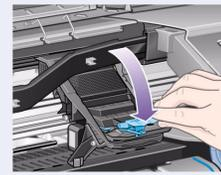
**8–Wenn Sie alle Setup-Druckköpfe durch normale Druckköpfe ersetzt haben,** klappen Sie die Druckkopfabdeckung über die Druckköpfe nach unten. Achten Sie darauf, daß die Haken der Abdeckung über der Verriegelung arretieren.
