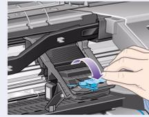
**2–Öffnen Sie die Verriegelung an der Druckkopfabdeckung.** Sie müssen diese Verriegelung während der nächsten Schritte ggf. mit der Hand nach unten gedrückt halten.
