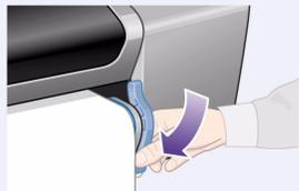
**13-Stellen Sie den blauen Papierladehebel nach unten.** Der Drucker überprüft die Ausrichtung des Papiers. Wenn es nicht korrekt ausgerichtet ist, erscheinen in der Bedienfeldanzeige entsprechende Anweisungen. Der Drucker schneidet die Kante der Rolle gerade ab.
