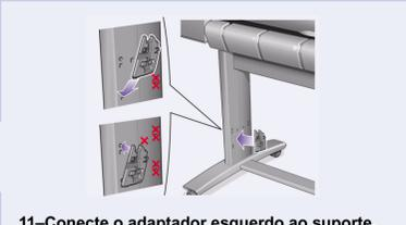
**11—Conecte o adaptador esquerdo ao suporte.** Está marcado com a letra 'L' e deve ser conectado na frente da perna esquerda. Se você precisar remover um adaptador, os dois trincos próximos ao topo devem ser soltos; insira um lápis ou ferramenta semelhante no buraco para soltar cada trinco.
