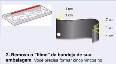
**2—Remova o "filme" da bandeja de sua embalagem.** Você precisa formar cinco vincos no filme para se encaixar nos porta-bandejas. Quatro destes vincos são a 1 cm e 2 cm de cada extremidade, na mesma direção, com um círculo de orientação no lado de fora. O terceiro também é na mesma direção e a 9 cm da extremidade mais distante do círculo.
