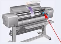
**1—Quando isso for pedido pelo painel frontal, abra a janela e localize a montagem do carro.** Isto fica acessível quando os tubos de tinta e os cabeçotes de configuração tiverem enchido de tinta.
