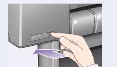
**2—Ligue a impressora se ela não iniciar automaticamente:** A chave liga/desliga está localizada na parte frontal esquerda. É um botão de luz verde (LED) para indicar quando está ligada. Ligue a alimentação pressionando o botão uma vez. Se a impressora não fizer nenhum som e o LED da chave não acender, há um problema de alimentação. Verifique as conexões do cabo e a fonte de alimentação.
