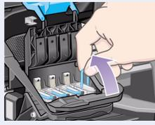
**4—Para remover um cabeçote de impressão de configuração,** levante a alça azul.
