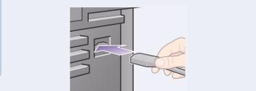
**1—Conecte o cabo de alimentação** no soquete na parte de trás da impressora e na tomada AC.
