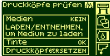
Im obigen Beispiel werden für einen oder mehrere Druckköpfe Meldungen für einen Austausch angezeigt. Um zu ermitteln, an welchem Druckkopf der Fehler vorliegt, wählen Sie das Druckkopfsymbol aus. Es wird der Status für alle Druckköpfe gleichzeitig angezeigt. Nach der Statusnummer erscheint eine kurze Anweisung. Nachdem diese Anweisung befolgt wurde, sollte der Status "Normal" erscheinen. Dies bedeutet, der Druckkopf ist fehlerfrei.
