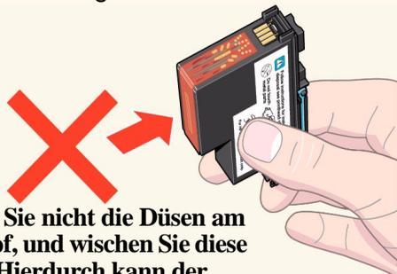
**Berühren Sie nicht die Düsen am Druckkopf, und wischen Sie diese nicht ab. Hierdurch kann der Druckkopf beschädigt werden.**
