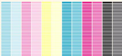
En los modos de alta calidad, y debido a la cantidad de tinta utilizada, los problemas de avance de papel podrán no aparecer como líneas de bandas, sino como un granulado excesivo. Las bandas o el granulado aparecerán en todos los colores.
