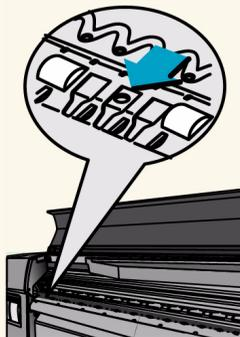
3. Repita el proceso hasta que haya aplicado diez gotas de aceite a todos los orificios de la platina.
