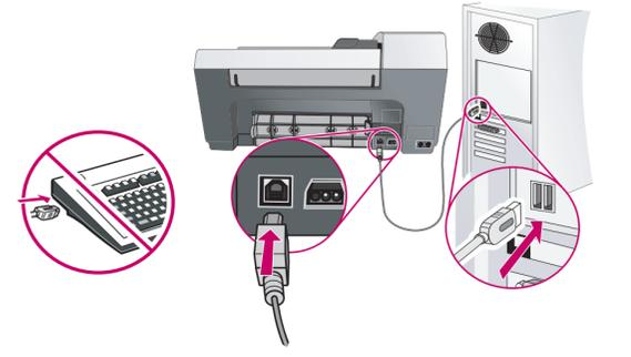
Controleer of het venster Installeer uw apparaat nu op het computerbeeldscherm is verschenen en sluit vervolgens de USB-kabel aan. Sluit de USB-kabel niet aan op een toetsenbord of een USB-hub zonder eigen voeding.
