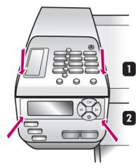
**a** Lijn het grote klepje uit met de knoppen aan de bovenkant van de HP Officejet en klik het vast.
