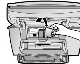
**e** Baje la traba derecha encima del cartucho de impresión y presiónela hacia abajo hasta que encaje en posición.
