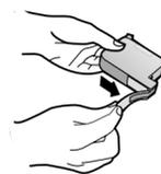
**d** Drücken Sie die schwarze Druckpatrone fest in den Schacht auf der rechten Seite. Achten Sie beim Einlegen der Patrone darauf, dass das Etikett nach vorn zeigt.
