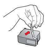
Drücken Sie die Farbdruckpatrone fest in die linke Halterung. Drücken Sie die linke Verriegelung nach unten, bis sie einrastet.
