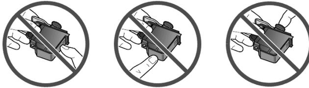
Fassen Sie die Kupferkontakte, die Tintendüsen und die Druckkopfnase nicht an.
