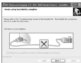
Σε κανονικές συνθήκες, εμφανίζεται ένα πράσινο σύμβολο ελέγχου το οποίο υποδηλώνει ότι η λειτουργία plug and play είναι επιτυχής. Ένα σύμβολο X υποδηλώνει ότι η λειτουργία plug and play έχει αποτύχει.
