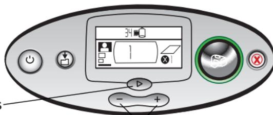
Utilisez les boutons de défilement **Vers le haut (+)** ou **Vers le bas (-)** pour afficher les réglages des différents paramètres.
