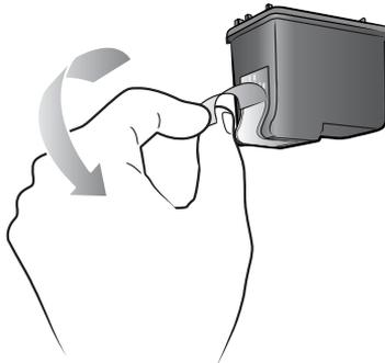
**Precaución:** No toque los inyectores de tinta ni los contactos de cobre del cartucho de impresión. Si se tocan estas partes se podrá estropear el cartucho de impresión.
