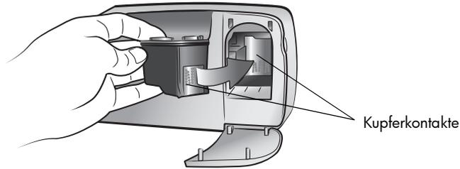
**5** Drücken Sie die Druckpatrone in den Druckpatronenhalter, bis diese einrastet.
