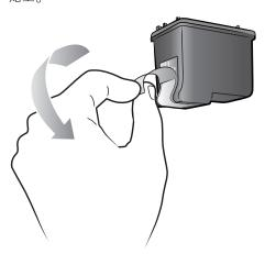
**小心!** 请勿触摸打印墨盒上的墨水喷嘴或铜触点。触摸这些部件可能会导致打印墨盒出现故障。
