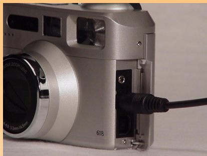
Figura 82: Cómo conectar el cable del adaptador de alimentación de CA de HP a la cámara
