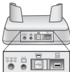
Sobre los conectores del equipo y de la impresora hay una puerta corredera que le impide utilizar ambos conectores al mismo tiempo (la base para cámara no es un hub USB).
