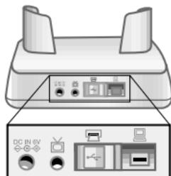
Há uma porta deslizante sobre os conectores do computador e da impressora, impedindo o uso dos dois conectores ao mesmo tempo (o encaixe da câmera não é um hub USB).
