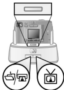
— Este botão ativa a conexão ao computador ou à impressora, dependendo do dispositivo conectado ao encaixe.
