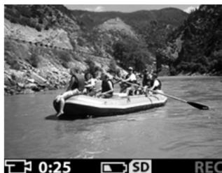
Durante a gravação, a luz vermelha do viewfinder pisca e a luz vermelha do vídeo/disparo automático fica contínua. Pode-se ver o tempo restante de gravação no visor. A câmera pára automaticamente quando o cronômetro chega a zero.
