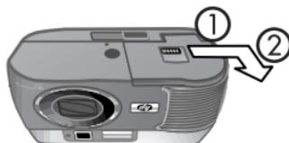
**2** Halten Sie die Verriegelung fest, und ziehen Sie die Batterieklappe zu sich heran.
