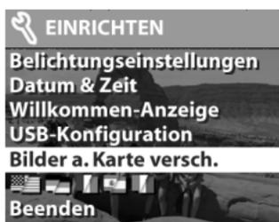
Reicht die Kapazität der Speicherkarte nicht aus, können Sie nur eine begrenzte Anzahl von Bildern verschieben. Wenn Sie die Frage nach dem Verschieben der Bilder mit **Ja** beantworten, werden die Bilder auf die Karte verschoben. Alle verschobenen Bilder werden aus dem internen Speicher gelöscht.
