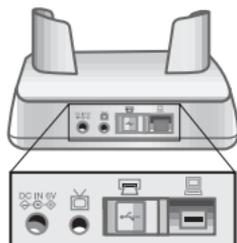
Die Anschlüsse für Computer und Drucker sind durch eine verschiebbare Abdeckung geschützt, die verhindert, dass Sie beide Anschlüsse gleichzeitig verwenden (die HP Kamera-Station kann nicht als USB-Hub verwendet werden).
