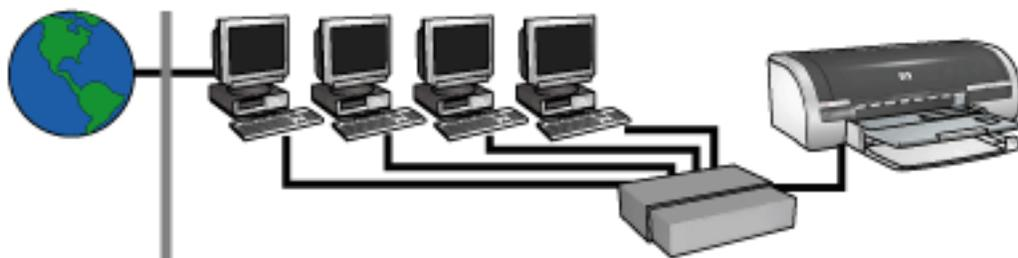
Dans cet exemple, les périphériques réseau sont connectés à un [concentrateur](#). Un ordinateur du réseau fait fonction de [passerelle](#) entre le réseau et Internet. Cet ordinateur utilise [ICS Windows \(Windows Internet Connection Sharing\)](#) pour gérer les connexions réseau et fournir un accès Internet aux autres périphériques.
