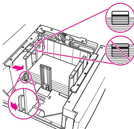
移动前和后纸张导架时必须使用绿色导杆。
