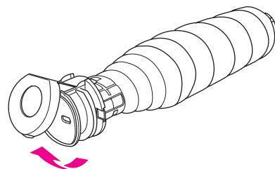
**6** 水平放置碳粉瓶，将碳粉瓶上圆环的位置对准碳粉耗材单元的凹槽。
