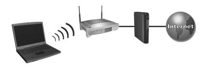
Le matériel requis pour une connexion Internet comprend un adaptateur WLAN installé dans le portable, un point d'accès sans fil et un modem. L'aspect du portable varie selon le modèle.
