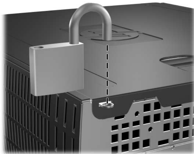
Installation d'un cadenas
