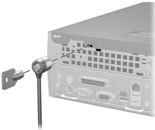
Installation d'un câble de sécurité
